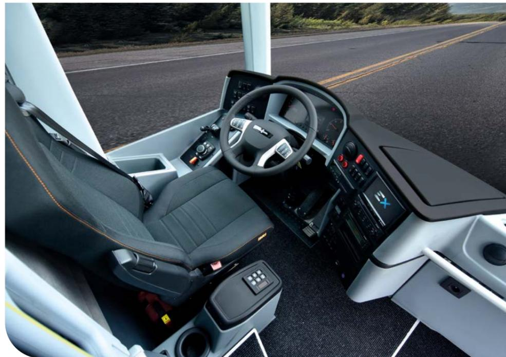
Das Lenkrad ist mit ergonomischen Bedienungstasten ausgestattet, mit denen sich Funktionen wie das Mediensystem, das Telefon und der Tempomat leicht bedienen lassen.
